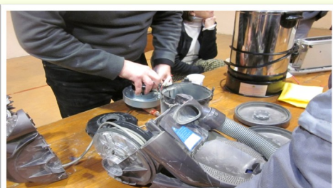
Avec un moteur neuf, l'aspirateur Fonctionne, après remontage.
